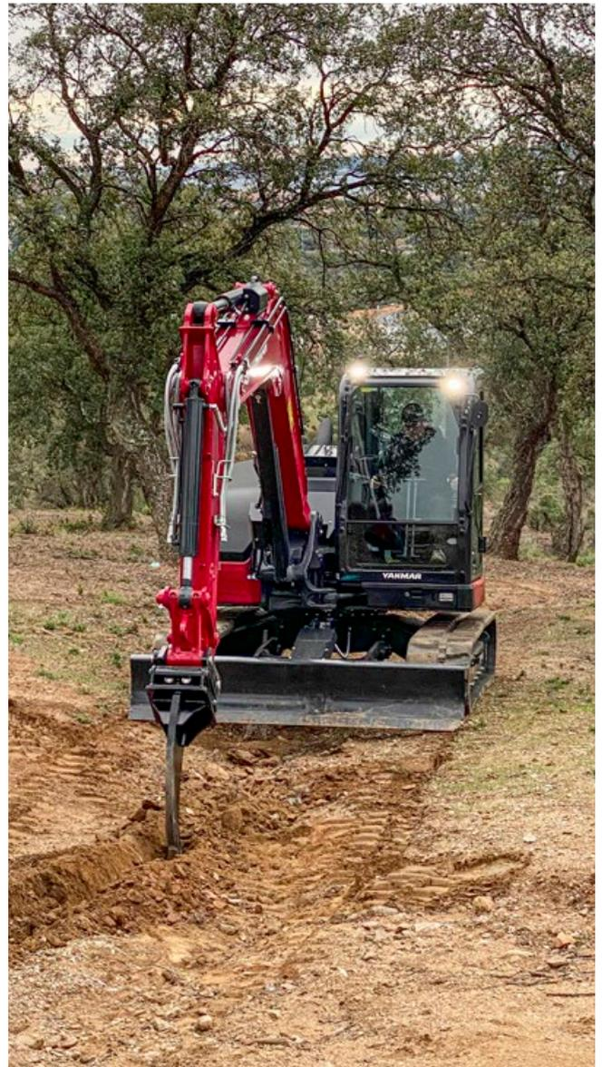
\*Der Test wurde mit 600 mm breiten Löffeln auf dem gleichen Gelände (Schotter), auf der gleichen Baustelle und unter den gleichen Wettervoraussetzungen ausgeführt. Dabei sollten drei verschiedene Bediener an jedem Bagger innerhalb von zehn Minuten einen 0,8 m tiefen Graben ausgraben.
