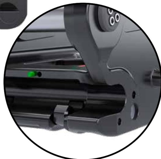
Positiver Anzeigestift (grün): Sichtbar, wenn das Anbaugerät sicher verriegelt ist.
