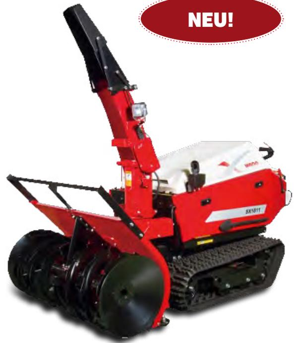
Die SX2211 ist eine universell einsetzbare Schneefräse und räumt problemlos auch Tiefschnee. Mit dieser 22 PS starken Diesel-Schneefräse sagen Sie dem Schnee den Kampf an.
