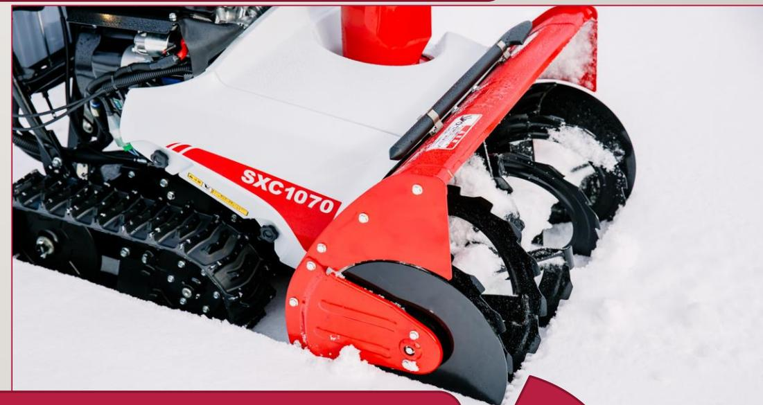
Einfaches drehen der Schneefräse, durch die plattenförmigen Seitenwände der Schnecke frisst sich die Fräse förmlich um Kurven
