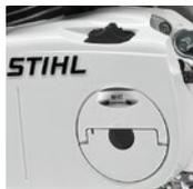
Ohne Werkzeug kann die Sägekette schnell und mühelos mit dem Stellrad gespannt werden. Beim Drehen des Stellrads nach links wird die Sägekette entspannt, beim Drehen des Stellrads nach rechts wird die Sägekette gespannt. Beim Festdrehen des Kettenraddeckels fixiert sich die Führungsschiene automatisch.
