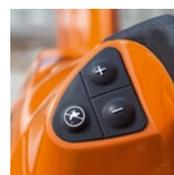
Bei laufendem Motor kann der Bediener über das Tastenfeld die elektronische Wassersteuerung einschalten. Drehzahlgesteuert schaltet sich dann das Wasser automatisch beim Schnitt zu und ab. Die Wassermenge kann ganz einfach durch Drücken der Plus-/Minus-Tasten reguliert werden. So sorgt man
