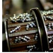
Die Nietbolzen der STIHL Sägeketten sind induktiv gehärtet, was die Struktur des Metallgitters verändert. Die Bolzen werden dadurch widerstandsfähiger.
