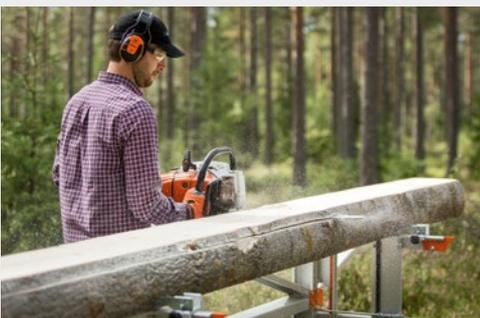
Spezielle Längsschnitt-Sägekette für den Einsatz auf Längsschnitt-Geräten sowie mobilen Kleinsägewerken. Halbmeißelzahnkette mit hoher Schnittqualität bei niedrigem Vibrationsniveau und weichem Schneidverhalten.
