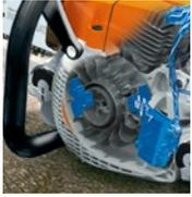
Das vollelektronische Motormanagement regelt in jedem Betriebszustand den Zündzeitpunkt und die Kraftstoffdosierung unter Berücksichtigung äußerer Bedingungen wie Temperatur, Höhenlage und Kraftstoffqualität. Es stellt durchweg eine optimale Motorleistung, konstante
