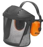
Leichte Kombination mit Gehörschutzkapseln für gute Lärmdämmung und schwenkbarem Nylonvisier, verstellbarer Kopfbügel, EN 352, EN 1731, SNR 24 (H : 28; M : 21; L : 13).<sup>Ⓢ</sup>
