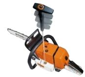
Als Folge des Kompressionsdruckes treten beim Anwerfen von Verbrennungsmotoren ruckartige Belastungen auf. Das Dämpfungselement im Spezialanwerfgriff ElastoStart nimmt entsprechend dem Verlauf der Kompression abwechselnd Kraft auf und gibt sie wieder ab. Dies bewirkt einen gleichmäßigen Anwerfvorgang.
