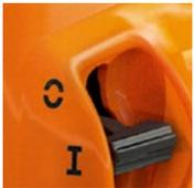
Nach dem Abschalten springt der Bedienelement selbstständig in seine Betriebsposition zurück. Die warme Maschine kann dadurch direkt wieder neu gestartet werden.
