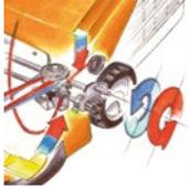
Die Geschwindigkeit des Radantriebs lässt sich unabhängig von der Drehzahl des Motors einstellen. So bleibt die Schnitt- und Fangleistung konstant. Der Antrieb ist stufenlos über einen Hebel am Holm regelbar.
