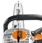
Zur besseren Richtungskontrolle beim Stechschnitt wurde die Stechleiste als erhabene Linie in das Design der Anwerfvorrichtung integriert.
