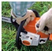
Mit dem gleichmäßigen Zug am Anwerfseil wird die Feder gegen den Verdichtungsdruck gespannt. Belastungen durch ruckartige Bewegungen werden vermieden. Die Feder gibt die gespeicherte Energie automatisch an die Kurbelwelle ab, setzt diese in Bewegung und sorgt für das zuverlässige Starten des Motors. Dies lässt eine um etwa zwei Drittel langsamere Anwerfgeschwindigkeit zu.
