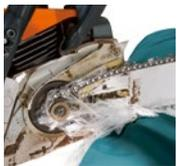
Der STIHL Schnittschutz besteht aus meist exklusiv für STIHL entwickelten Schnittschutzmaterialien. Die STIHL Schnittschutzkleidung wird bei den renommiertesten europäischen Testinstituten SMP oder KWF getestet. Der Schnittschutz hat mehrere
