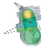
Der STIHL 2-MIX-Motor ist leistungsstark und sparsam zugleich. Die Trennung von Abgas und Frischgas minimiert die Spülverluste und erhöht dadurch die Leistung und reduziert gleichzeitig den Verbrauch.
