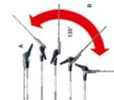
Der Messerbalken lässt sich stufenweise um bis zu 145° (HL 94), bis zu 115° (HLA 65, HLA 85), bis zu 135° (HLA 56), bis zu 125° (HLE 71)
