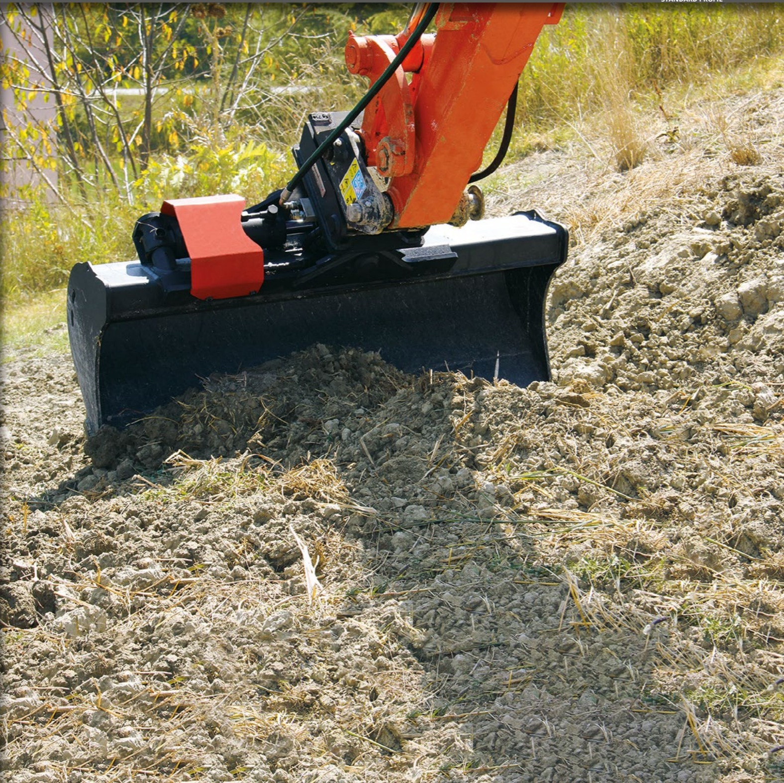
IDEAL ZUM EINEBNEN UND FÜR FEINARBEITEN. BEIDSEITIG 45° SCHWENKBAR- UND DANK SERIENMÄSSIGEM BLOCKVENTIL FESTSTELLBAR.
