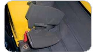
Das Pedal für den Zusatzkreis sowie das Pedal für das Ausleger-Schwenken werden durch die Abdeckungen vor dem Risiko ungewollter Bewegungen geschützt.
