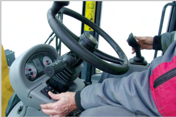
Einstellung der Ölmenge des dritten und vierten Kreises ueber das Display.
